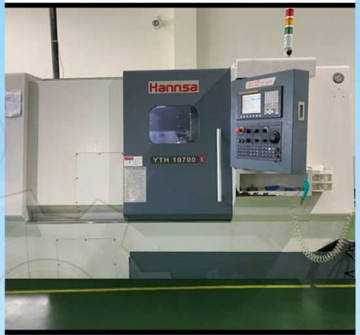
Máy tiện CNC/CNC Lathe : HANNSA YTH10700-E
